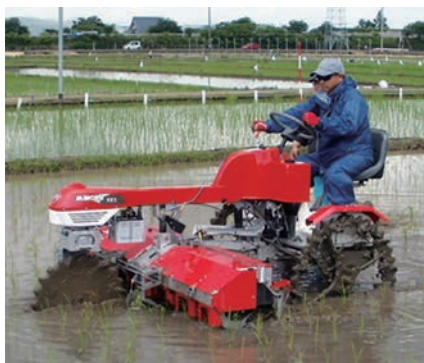
写真1 乗用型水田除草機の除草作業風景 (福井農試提供)
