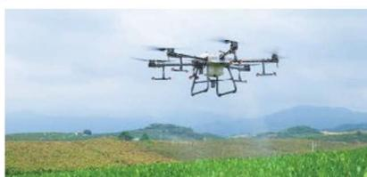
飛行ルートを設定するだけで、自動で散布作業が行えます。さらにオプションのRTK基地局を併用することで、誤差数cmレベルの高精度な散布を実現します
