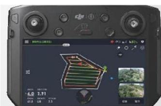
ほ場のカチに合わせて周囲を散布する額縁散布モードが追加されました。これまで散布が困難だった地形を、高精度に散布することができます。散布残しや誤って近隣ほ場へ散布してしまうことも防げます。
